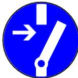
Desligue a unidade antes de iniciar o trabalho de manutenção. Veja a documentação do sistema do sistema de refrigeração para isso. Proteja a unidade contra a ligação involuntária novamente removendo os fusíveis elétricos da unidade. Prenda a unidade com um sinal de aviso adequado, referindo-se à ativação não intencional
