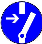
Desligue a unidade antes de começar o trabalho de manutenção com o qual você deve remover a grade de proteção. Proteja a unidade contra a ligação involuntária novamente, removendo os fusíveis elétricos da unidade. Fixe a unidade com um sinal de aviso adequado, referindo-se à ativação não intencional.
