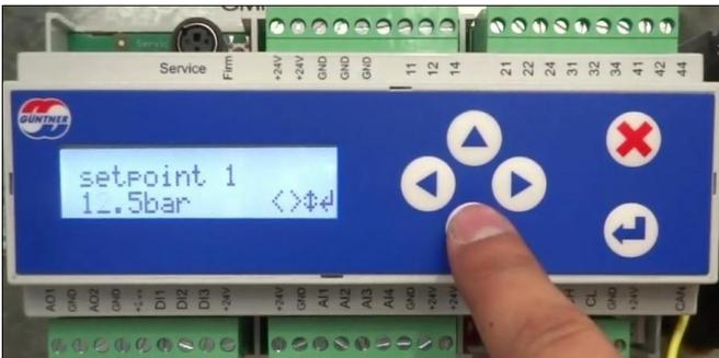
**6° PASSO:** após o ajuste do valor de setpoint pressione a tecla enter novamente. na sequência pressione a tecla x para retornar ao menu status.
