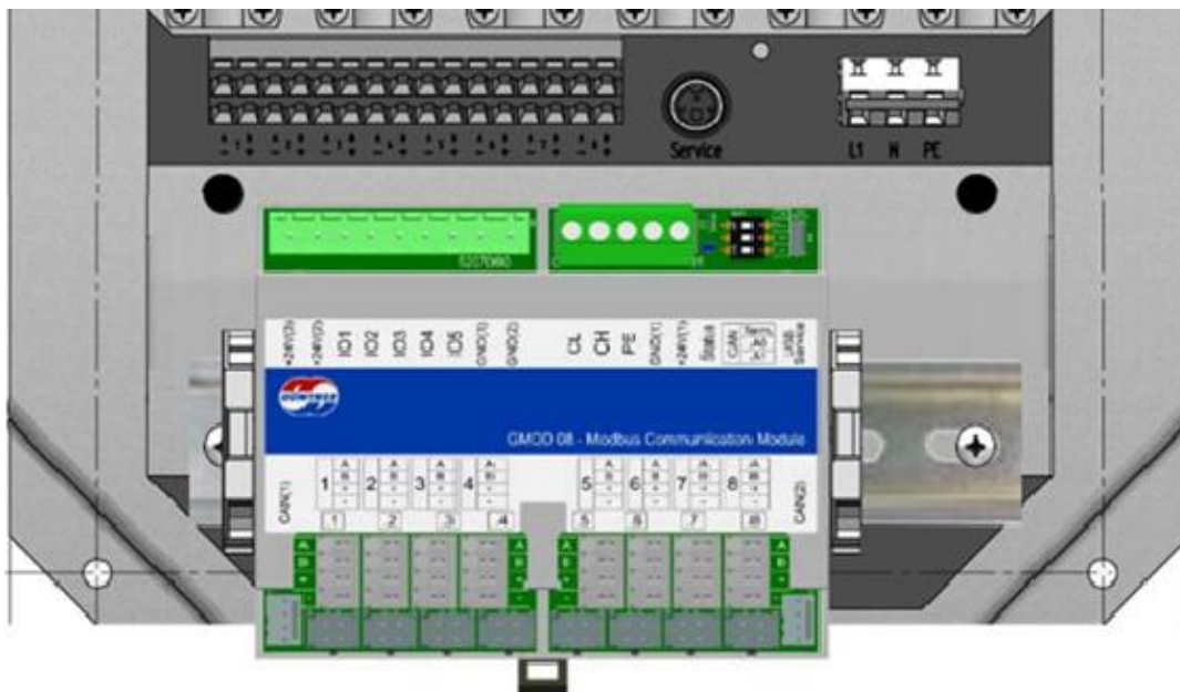
Figura 11: Fixação do módulo GMOD 08 Rail.
