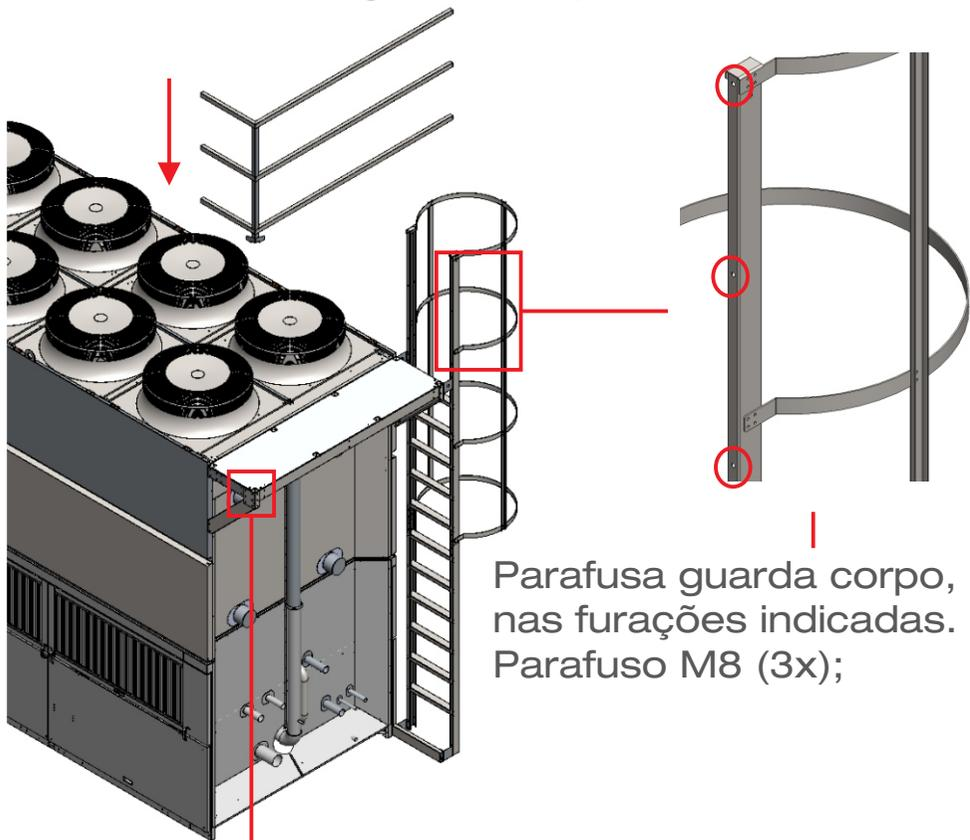
Parafusa guarda corpo, nas furações indicadas. Parafuso M8 (3x);
