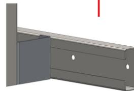
Usar perfis 'U' para fixar parte superior da escada. Parafusos M8 (8x);
