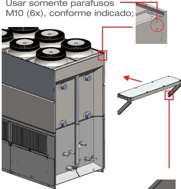
Usar furações conforme destacado para fixação do reforço da plataforma. Parafuso M10 (4x);
