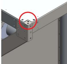
Usar furos mostrado, para fixar guarda corpo na plataforma. Usar parafusos M8 (2x);
