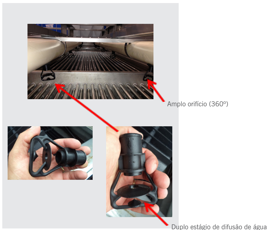
Figura 7: Posição e distribuição de água dos bicos aspersores
