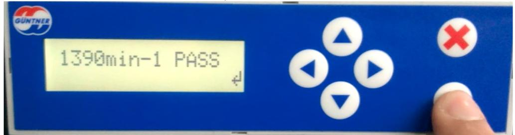
7B) Pressione "Enter" para selecionar o tipo de trocador de calor
