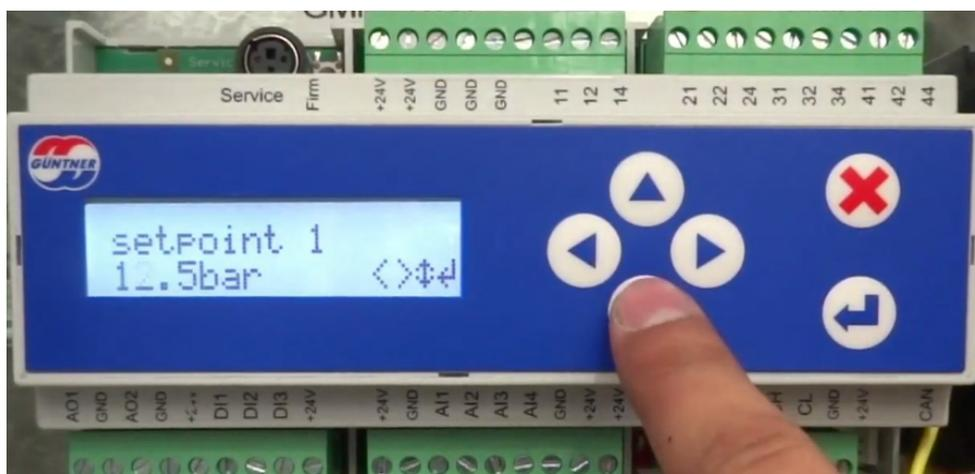
7) Após o ajuste do valor desejado pressione “Enter” novamente. E pressione a tecla “X” para voltar ao menu de Status.
