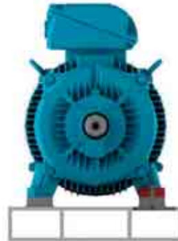
Bild 6.3 - Motor auf metallische Basis aufgestellt
