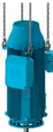
Рисунок 4.8 - Подъем электродвигателей серий HGF и W50.
