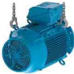
Bild 4.19 - Endergebnis: der Motor liegt in horizontaler Lage
