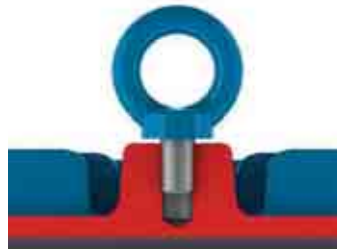
Рисунок 4.2 - Неправильное затягивание рым-болта
