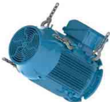
Фигура 4.18 - Двигателят се завърта в хоризонтално положение
