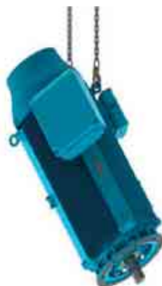
Рисунок 4.14 - Подъем электродвигателей серий HGF и W50 за рым-болты на глухом торце
