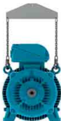
Рисунок 4.6 - Использование распорной траверсы при подъеме
