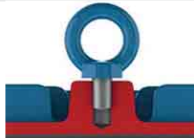
Фигура 4-2 – Неправилно затягане на болта с халка
