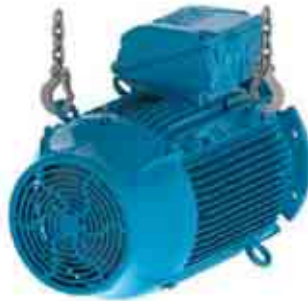
Рисунок 4.19 - Конечный результат: электродвигатель расположен горизонтально
