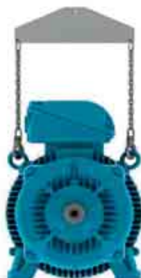
Figura 4.6 - Uso de barra separadora no içamento
