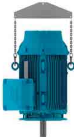
Bild 4.7 - Handhabung von vertikal aufgestellten Motoren
