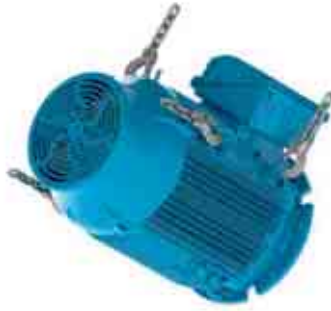
Рисунок 4.18 - Вращение двигателя в горизонтальное положение
