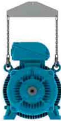
Bild 4.6 - Einsatz eines Querbalkens zum Heben
