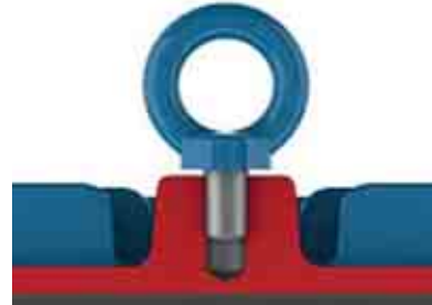
Figurii 4.2 - Strângerea incorectă a unui șurub cu ochi
