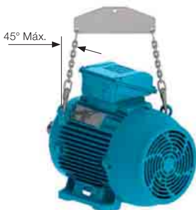
Figura 4.4 - Ángulo máximo resultante para motores con dos o más cáncamos de elevación
