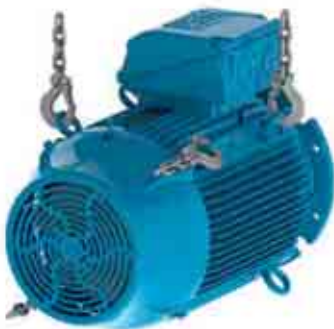
Figura 4.10 - Instalación del segundo par de cáncamos
