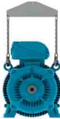
Figura 4.6 - Uso de barra separadora en la elevación
