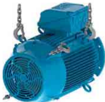
Figurii 4.10 - Instalarea celei de-a doua perechi de șuruburi cu ochi
