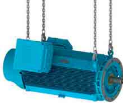
Bild 4.12 - Den Motor der Baureihe HGF und W50 an den vier seitlich angebrachten Transportösen mit zwei Hebevorrichtungen heben
