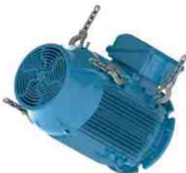
Figurii 4.18 - Motorul este rotit în poziția orizontală
