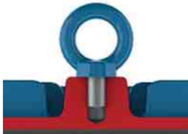
Figurii 4.1 - Strângerea corectă a unui șurub cu ochi
