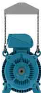
Figurii 4.6 - Utilizarea unei bare distanțier pentru ridicare
