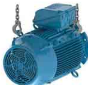
Фигура 4-9 – Изваждане на двигателя от опаковката
