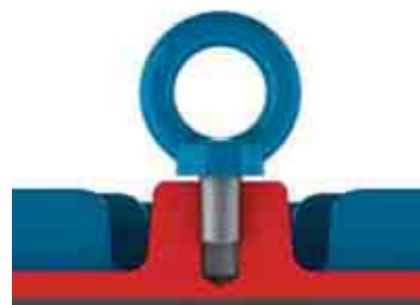
Bild 4.2 - Falsche Befestigung der Transportösen
