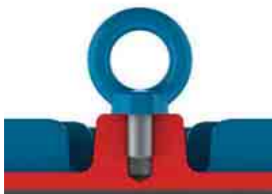
Bild 4.1 - Richtige Befestigung der Transportösen
