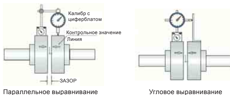
Рисунок 6.11 - Выравнивание с помощью калибра с циферблатом
