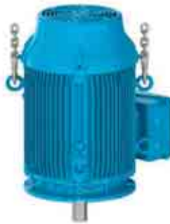
Figura 4.16 - Instalação do primeiro par de olhais
