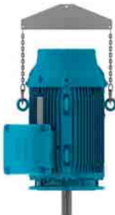
Figura 4.7 - Içamento de motores verticais
