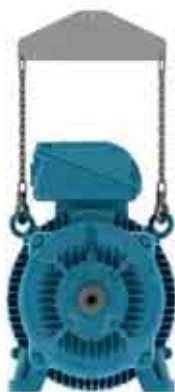
Фигура 4-6 – използване на раздалечителен елемент
