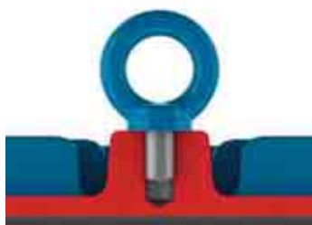
Рисунок 4.1 - Правильное затягивание рым-болта
