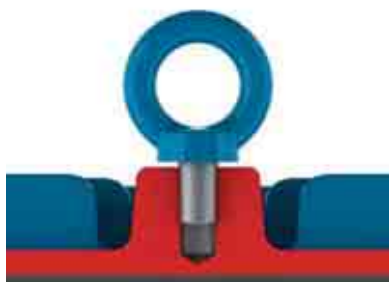
Figura 4.2 - Maneira incorreta de fixação do olhal de içamento
