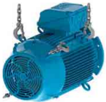
Figura 4.10 - Instalação do segundo par de olhais
