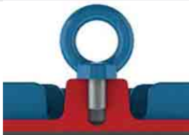
Фигура 4-1 – Правилно затягане на болта с халка
