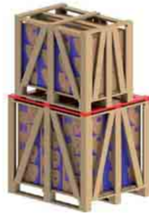
Figura 5.5 - Utilización de varas adicionales para apilamiento
