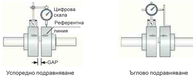
Фигура 6-11 – Подравняване с уреди с цифрова скала
