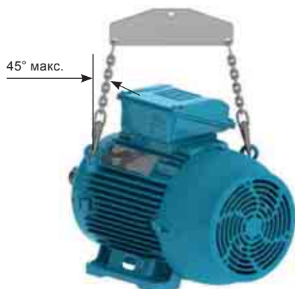
Фигура 4-4 – Максимален ъгъл за двигатели с два или повече болта с халки
