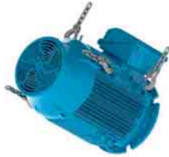
Figura 4.18 - Motor está sendo girado para a posição horizontal
