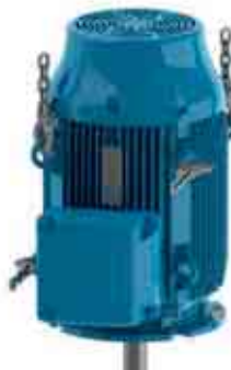
Bild 4.17 - Einbau des zweiten Paares Transportösen
