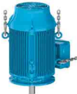
Figura 4.11 - Resultado final: motor posicionado de forma vertical
