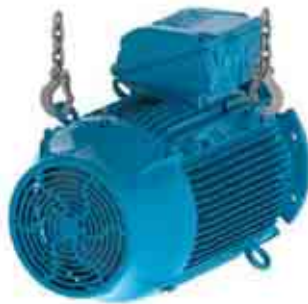
Figura 4.19 - Resultado final: motor posicionado na posição horizontal
