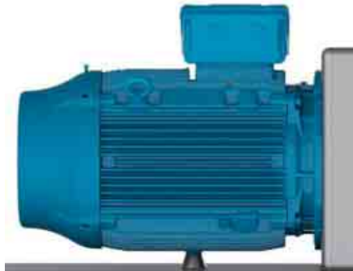
Figura 6.7 - Representación de la fijación del motor con brida y apoyo en la base de la carcasa
