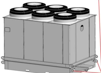
2- Elevar equipamento pelos olhais superiores para colocação das barras de elevação.
