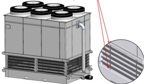
4- Posicionar caixa CIRCUITO FECHADO e fixar conjunto bomba através das uniões.
