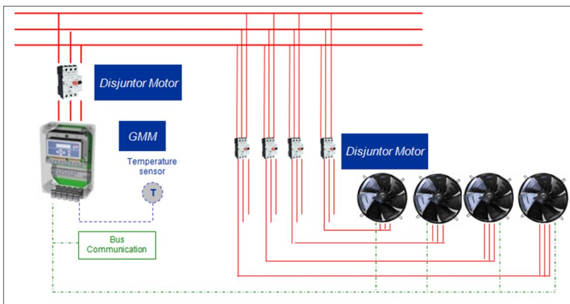
Figura 3: Configuração do sistema com ventiladores EC + GMM.
