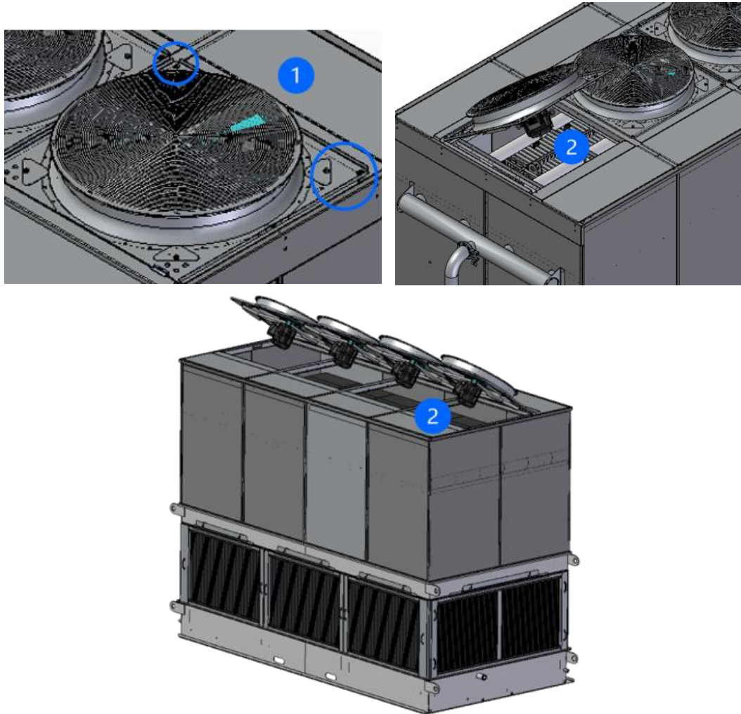
Figura 28 – Abertura motor GTECH
