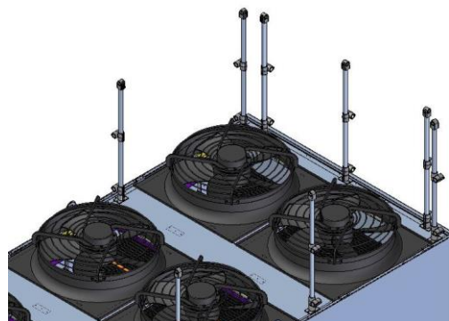
Figura 4: Montaje Columnas GC
