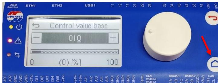
15. NOTA: si el equipo tiene más de un sensor de temperatura o presión, es necesario configurar la entrada analógica correspondiente.
