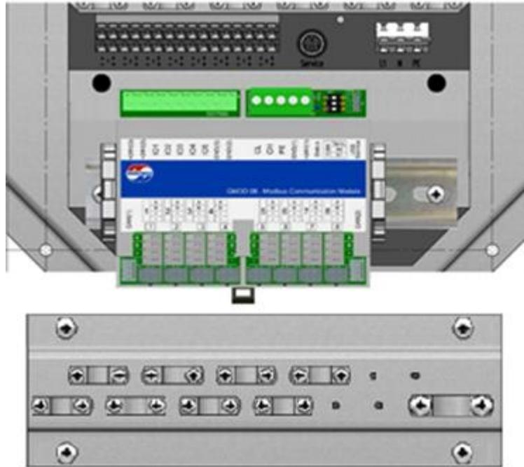
Figura 11: Fijación de barra de protección.
