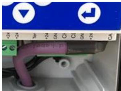
Figura 17: Cable de comunicación CAN.
