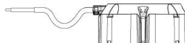
Fig. 1: Instalação com eixo do motor vertical, cabo roteado em loop em U
