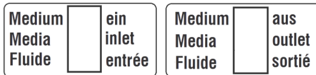
Imagem 3: Sinalização de fluídos
